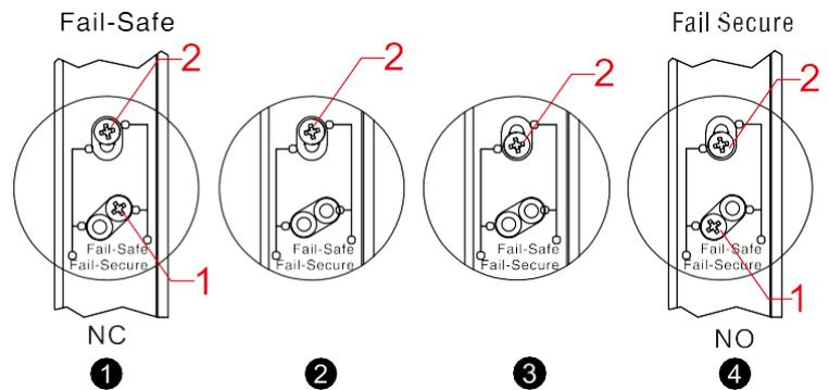
**DESAPERTAR** o parafuso 2 e mover ligeiramente, **SEM RETIRAR**. Se o parafuso for retirado, a válvula magnética irá soltar-se do corpo da fechadura.
