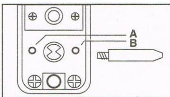
Rosque o perno de fixação do trinco
