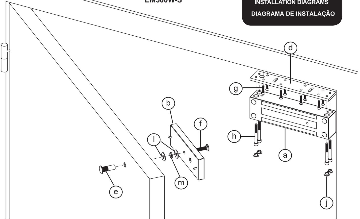
Insérer la rondelle caoutchouc (m) entre les rondelles métalliques (l) en évitant de serrer l'ensemble trop fortement afin de conserver la mobilité de la contreplaque.
