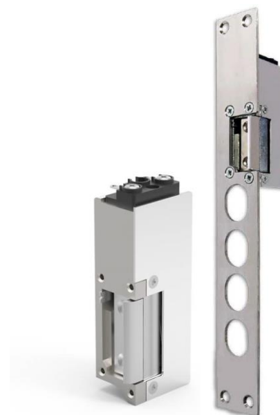
9X0P10 L Trinco eléctrico porta blindada, 12V DC, mão de porta direita
