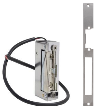
TW-5UW Trinco eléctrico à prova de água IP66, fail-secure (sem alimentação, porta fechada) com espelho
