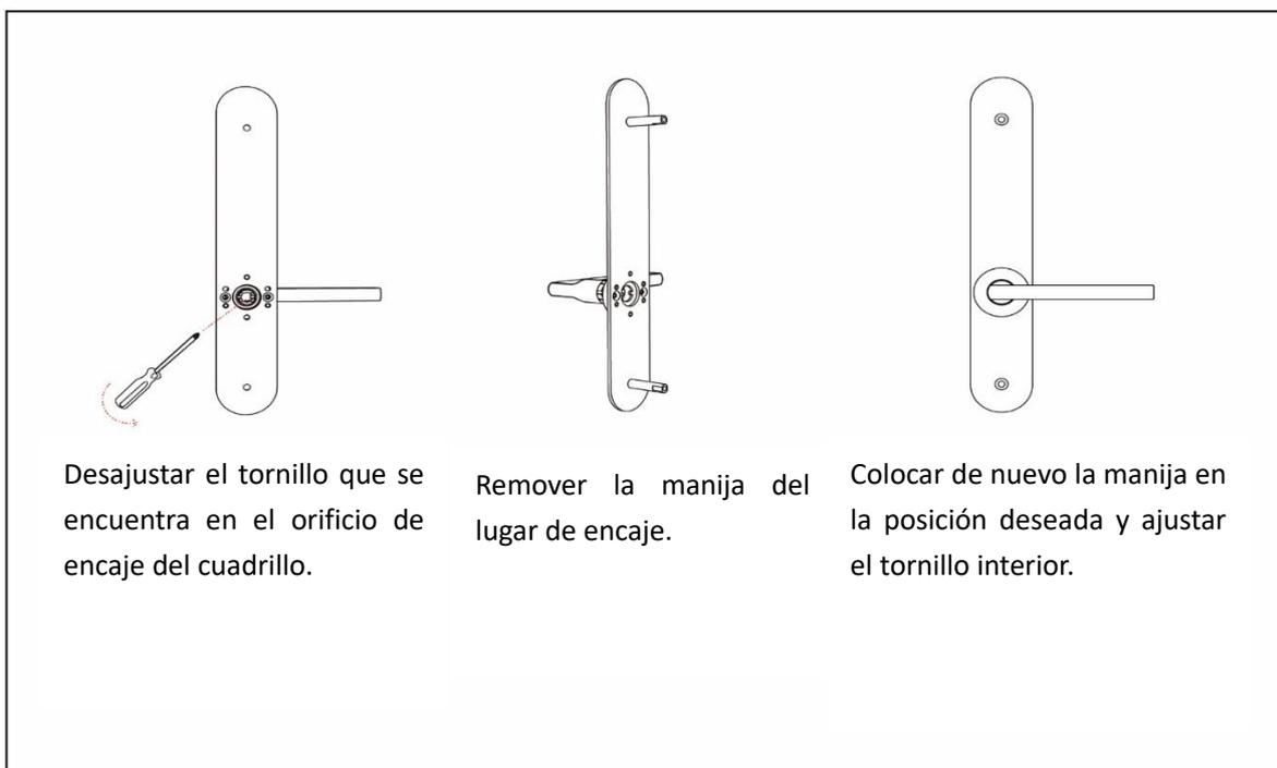
Desajustar el tornillo que se encuentra en el orificio de encaje del cuadrillo.
