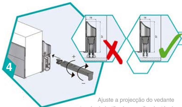
Ajuste a projecção do vedante através do botão de pressão ajustável. Evite demasiada pressão para não causar deformação do vedante
