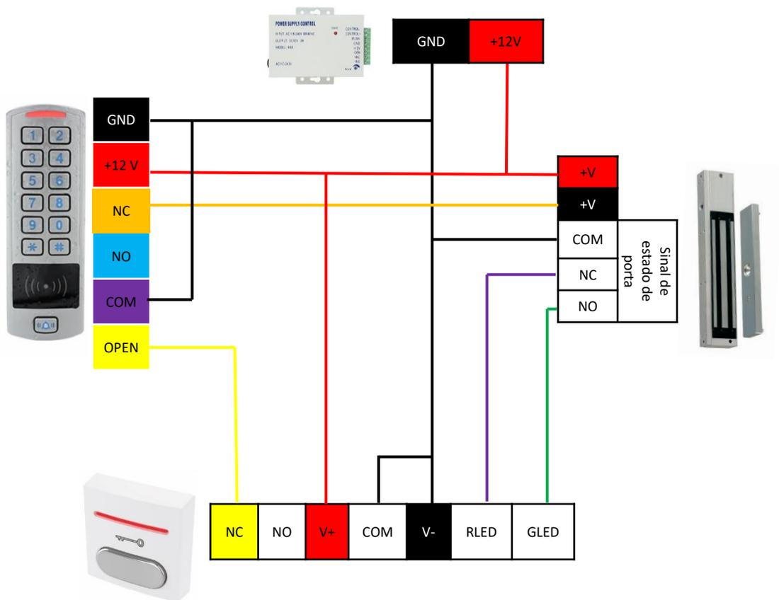
**NOTA** – O Botão PBAL1 tem controlo externo LED, para o funcionamento do botão para abrir a fechadura eletrónica é independente do controlo do LED do botão ou seja os contactos RLED/GLED/V+/V- são apenas nos casos que seja pretendido o LED ligar ou seja controlado pelo sinal de porta (Verde quando pressionado ou vermelho em standby)
