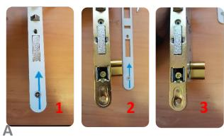
Después de embutir el cuerpo de la cerradura en la puerta, retirar la placa frontal de la cerradura y atornillar el cilindro usando el tornillo provisto.
