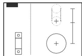
La flecha del eje cuadrado
