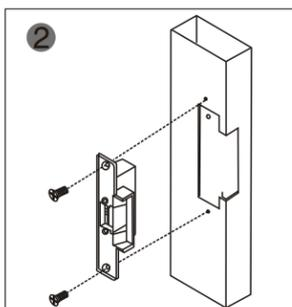
2 Montar a fechadura e ligue a alimentação para testar.
