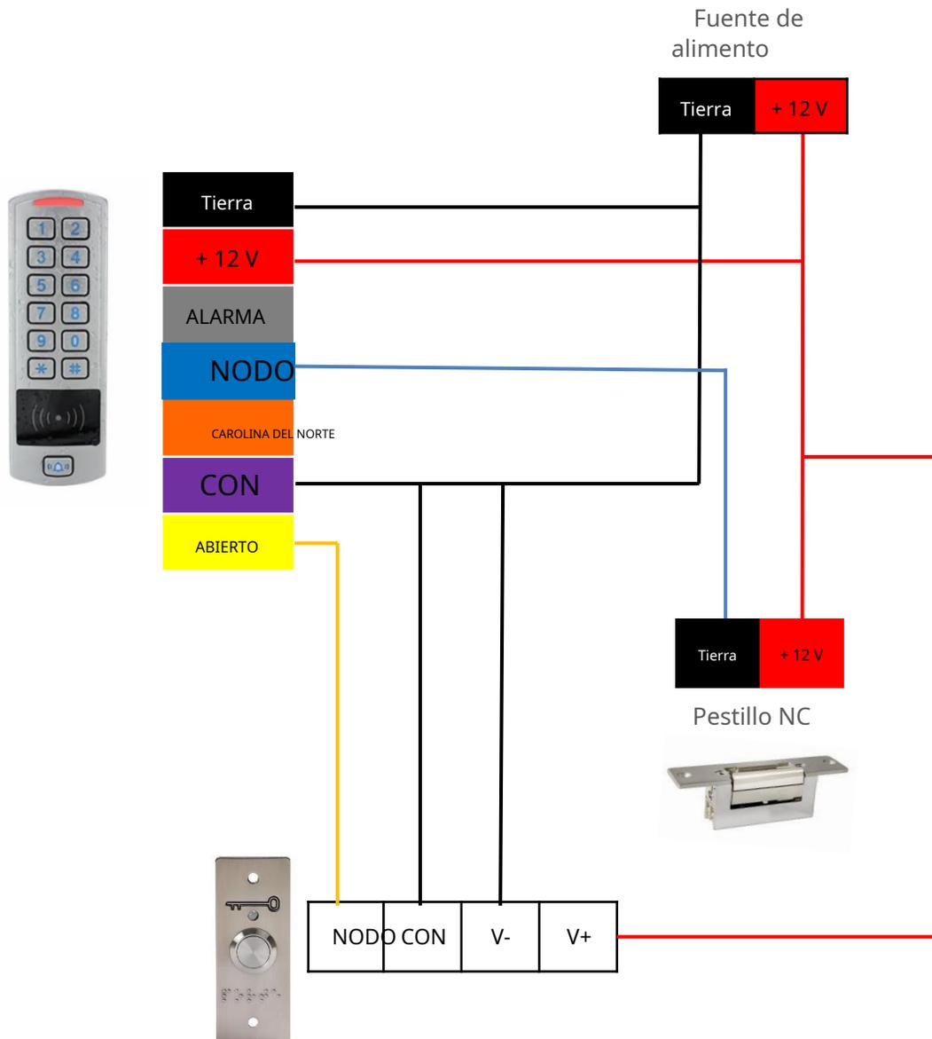
Nota: Al conectar el PB19BB junto con un control de acceso, se recomienda configurar el interruptor del temporizador del Botón a 0s. De esta manera el control de acceso controlará el tiempo que la cerradura electrónica permanece abierta.
