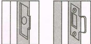
Perfore o corte un hueco para el pestillo y fije el espejo con un tornillo. Compruebe que el espejo esté en la posición correcta y apriete el segundo tornillo. Tenga en cuenta que el pestillo consta de dos partes: una es un bisel. (cerradura) y otro con forma cilíndrica (freno)
