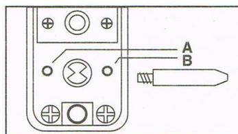
Atornille el pasador de fijación del pestillo. El perno debe apretarse en el orificio A si el puerto está a la derecha y en el agujero B si esta a la izquierda.
