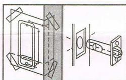
Marque el centro del pestillo en la parte superior de la puerta. Perfore un orificio de 25 mm y 85 mm de profundidad. Inserte el pestillo en el orificio y trace el rectángulo del espejo con un lápiz.
