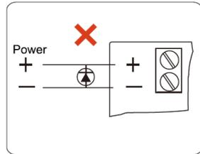
No instale un diodo en paralelo con ningún otro cerradura magnética, ya que provocará un retraso en la apertura de la puerta.
