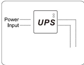
El electroimán es a prueba de fallos. Se recomienda usar una fuente de alimentación con batería de respaldo para que, en caso de corte de energía, la puerta no permanezca abierta.
