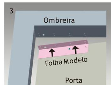
3 Marcar na porta e ombreira o sítio dos parafusos na placa de encaixe;
