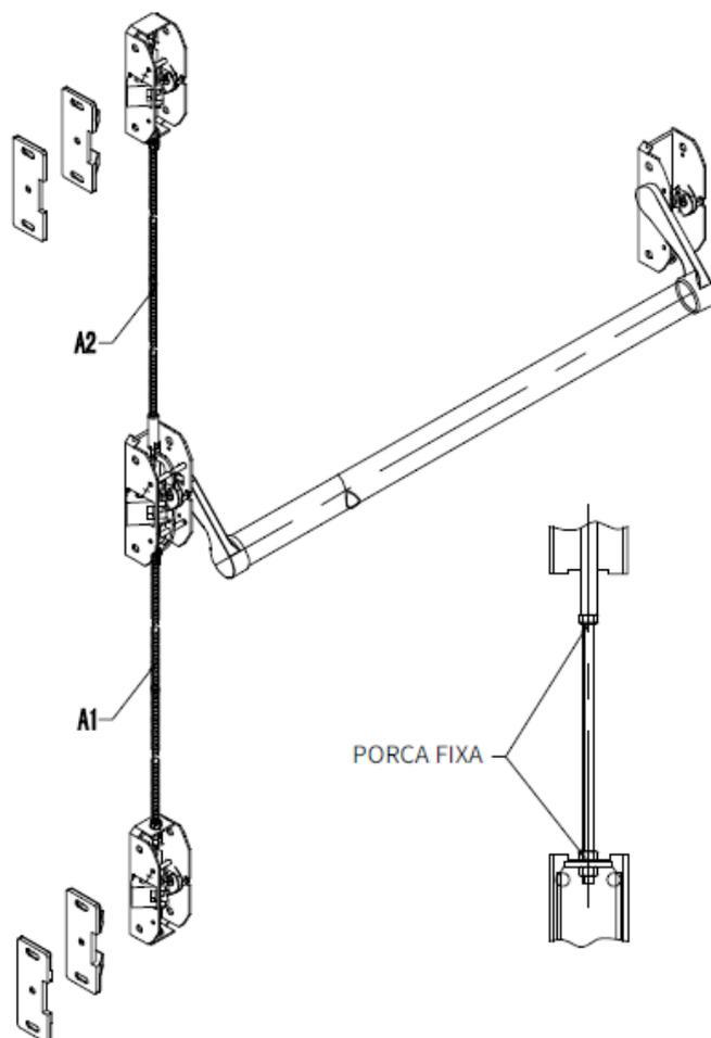
6. Instale as tampas na sequência correcta e teste em cada passo:
