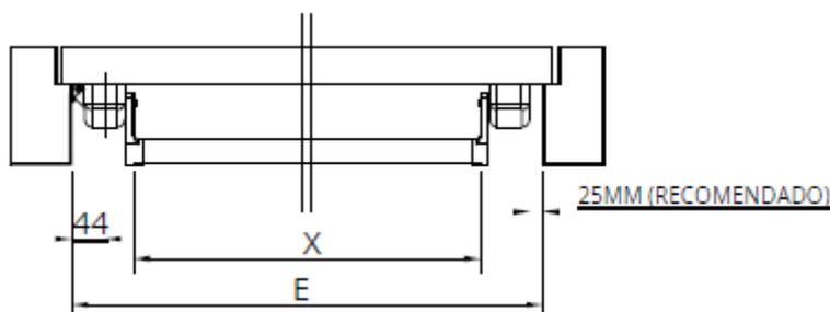
4. Se o comprimento da porta for inferior a 1000mm, corte a barra:
