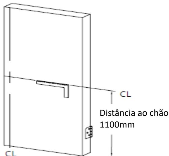
3. Determine o comprimento da barra:
