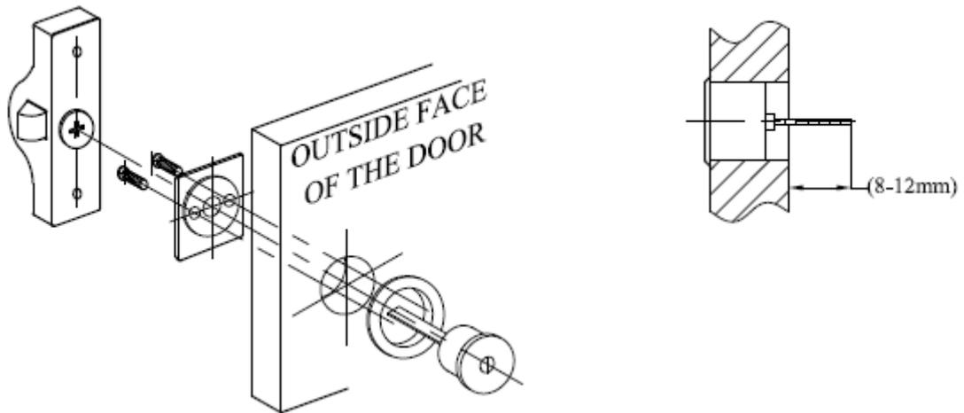
4. Instale o puxador com trinco embutido e aperte firmemente os parafusos;
