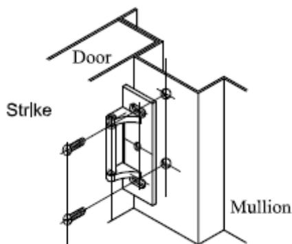
7. Instale o espelho do trinco alinhado com o trinco da barra;
