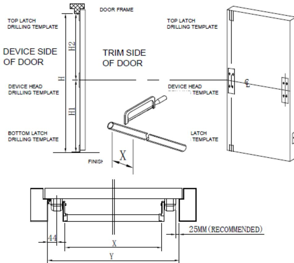
5. Se o comprimento da porta for inferior a 1000mm, corte a barra:
