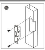
Montar la cerradura y conectar para hacer una prueba.
