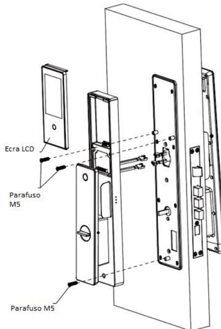
7. Coloque a bateria e o ecrã LCD, Pressione o botão de abertura e o de fecho para testar se a fechadura está a funcionar correctamente
