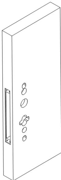
2. Aplique a caixa mecânica e o cilindro e aperte os parafusos de fixação respectivos
