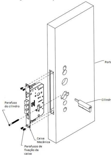
3. Corte o comprimento do veio do cilindro para se adaptar à espessura da sua porta.
