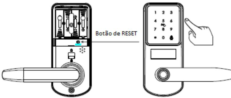
O botão de reset encontra-se abaixo do compartimento das pilhas. Pressione o botão durante 3 segundos, a fechadura irá emitir “please input initialization passcode”, digite 000#, a fechadura emite “successful”. Quando a fechadura está com as configurações de fábrica pode abrir com qualquer código ou impressão digital. O código mestre de fábrica é 123456.
