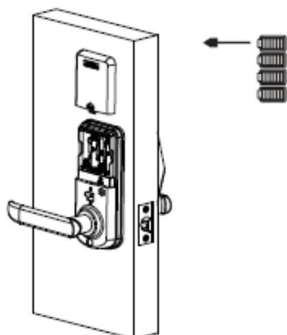
Após terminar a instalação ajuste o aperto dos parafusos. Nota: se os parafusos estiverem muito apertados o puxador não movimenta com facilidade. Depois teste a abertura com o código mestre 123456
