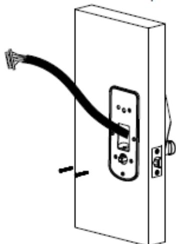
Conecte o cabo eléctrico com a placa e
