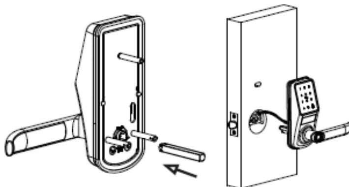
Aparafuse a placa do painel traseiro com os 2 parafusos M4x30
