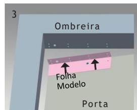
3 Marcar na porta e ombreira o sítio dos parafusos na placa de encaixe;
